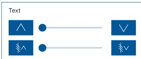
Abbildung 23: Darstellung – Jalousie/Rollladen mit Höhen- und Lamellenposition: Slider
