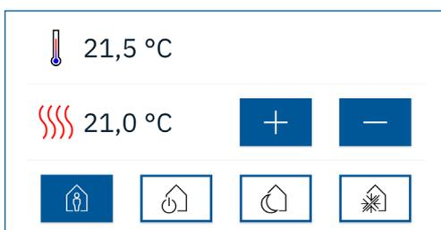
Abbildung 25: Darstellung – Raumtemperaturregler mit HVAC Mode
